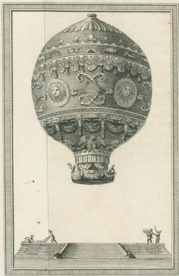
Aërostatische Maschine 70 Schuhe hoch und 46 Schuhe im Durchschnitte die den 19 Oct. 1783 zu Paris mit zwey Personen 324 Schuhe in die Höhe gestiegen.—
